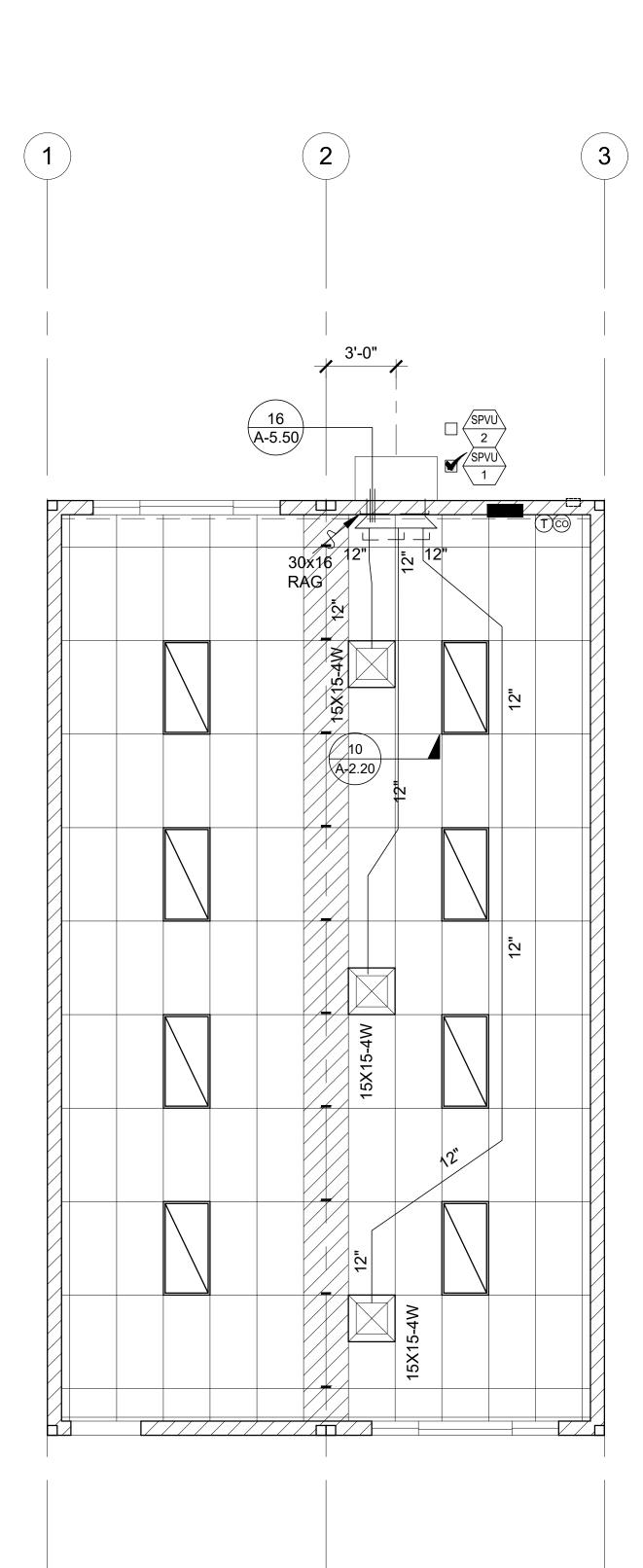
MECHANICAL PLAN - STANDARD 4 LIGHT CONFIGURATION
